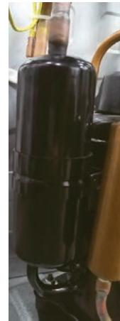
La bouteille tampon est située dans le circuit de la conduite d'aspiration à l'entrée du compresseur. La bouteille tampon contribue à empêcher le réfrigérant liquide de pénétrer dans le compresseur durant une phase de fonctionnement.
