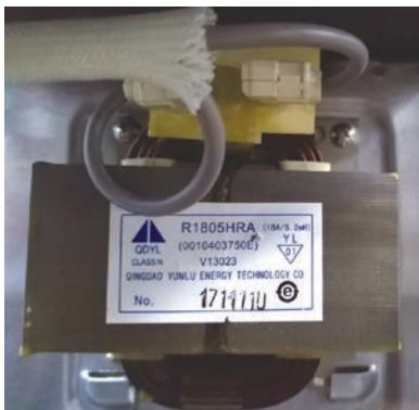
La bobine de réactance constitue un filtre inductif qui participe à la correction de l'influence du facteur de puissance électrique de la capacitance de l'onduleur. Il est peu probable que survienne une défaillance électrique de ce composant.
