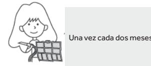
4. Adhiera el filtro: Adhiera el filtro de modo que la etiqueta "FRONTAL" mire hacia afuera. Asegúrese de que el filtro se encuentre adherido de forma segura detrás de las lengüetas de suspensión. Si el filtro no se encuentra correctamente adherido, la unidad no podrá alcanzar su máxima eficiencia.
