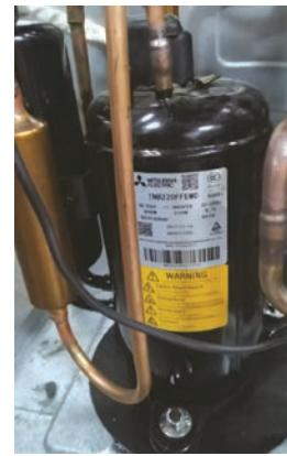
Le compresseur est de type rotatif, contrôlé par onduleur triphasé CC. Le compresseur peut fonctionner en vitesse variable. La fréquence de fonctionnement du compresseur est déterminée par la différence de température entre le point de réglage et la température ambiante intérieure ou extérieure. (Mode climatisation versus mode chauffage)
