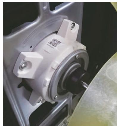
Le moteur de ventilateur extérieur est à vitesse variable. La vitesse requise est calculée par la carte de commande principale. Le moteur est connecté électriquement à la carte de commande principale par la FICHE CN-21.
