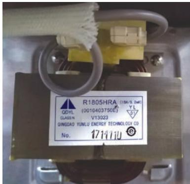
El Reactor es un filtro inductivo que ayudará en la corrección de la influencia del factor de corriente eléctrica de la capacitancia del inversor. Es improbable que alguna vez este componente sufra una falla eléctrica.
