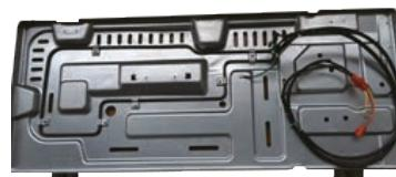
El sistema posee un calefactor de la bandeja de la base eléctrica para la descongelación.
