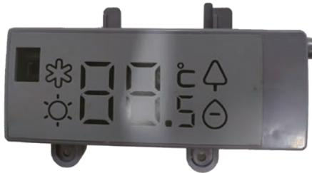
L'afficheur intérieur est doté d'un circuit de communication à infrarouge qui reçoit les commandes de fonctionnement de la télécommande. Cet afficheur indique les modes, les codes d'erreur, la température de l'air intérieur, l'état de la minuterie et de l'alimentation.
