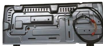
Le système est doté d'un élément qui chauffe le plateau de base pour le dégivrage.
