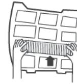
4. Fixez le filtre : Fixez le filtre de façon que l'étiquette « FRONT » (avant) soit face à l'extérieur. Assurez-vous que le filtre est bien fixé derrière les languettes de retenue. Si le filtre n'est pas fixé correctement, l'appareil peut ne pas atteindre son efficacité maximale.
